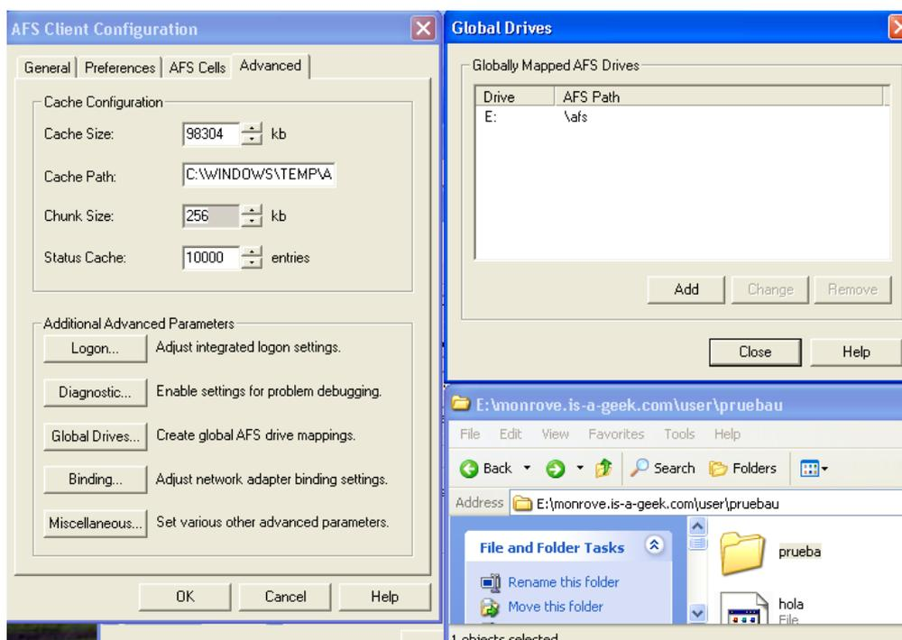
Podemos ver en la parte inferior de la captura como hemos podido acceder al directorio afs del usuario pruebau, con el que nos hemos identificado mediante tickets kerberos.
