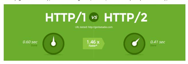
• En la siguiente foto podemos ver otro ejemplo de la diferencia entre los dos protocolos, en este caso se observar la diferencia de latencia en ambos protocolos.
