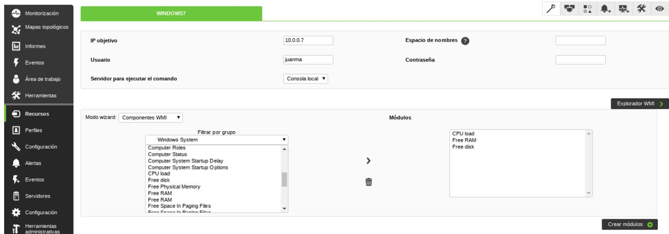
Le damos a “**Crear módulos**” y ya tendríamos los módulos con sus gráficas disponibles para su visualización. Por ejemplo nos dirigimos a “**Monitorización** → **Vistas** → **Vista de agentes/módulos**” y observamos la carga de la CPU de la máquina Windows con sus umbrales de alerta:
